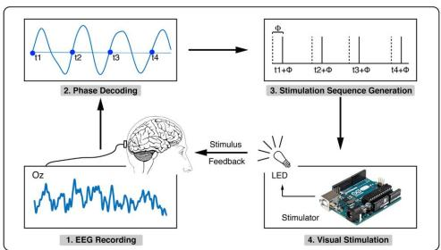
下図は実験の手続きで、1. 脳波を記録する。2. 位相を decode する。3. 位相  $+ \Phi$ の位置で刺激するための sequence を発生する。4. その sequence に合わせて LED ランプをつけ、 $\alpha$  波を modulate する。結果を簡単に説明する。
